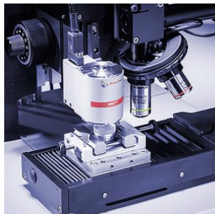
Nano-indentation instrumentée à SafranTech
